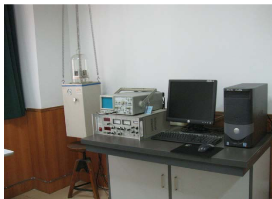
地点：科技楼 C 区 203B 实验：扫描隧道显微镜 负责人：樊洁平
