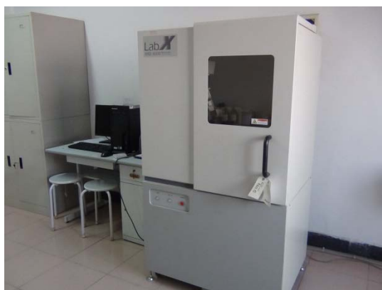
地点：科技楼 C 区 203A 实验：X 射线多晶粉末衍射 负责人：樊洁平
