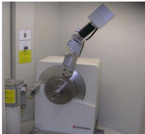
图（2）X 射线衍射仪的样品台与转角仪。
