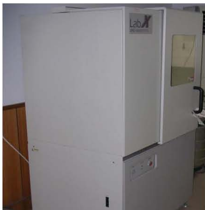
图（1）X 射线多晶衍射谱测量系统。
