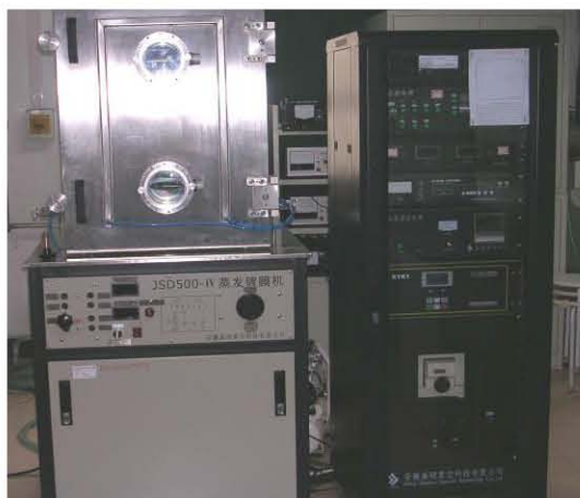
图（1）真空蒸发镀膜系统。
